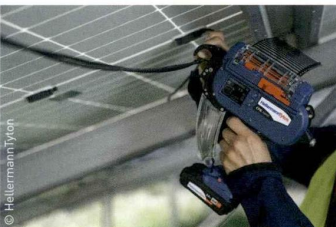
L'outil de pose automatique des colliers CPK hybrid.
