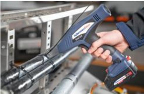
Associé à une poignée ergonomique avec un revêtement antidérapant, le Procut réduit considérablement la fatigue de la main et les risques de TMS (Troubles Musculo-Squelettiques) associés. Seconde innovation : une deuxième gâchette montée à l'arrière de l'outil permet les manipulations dans les endroits difficiles d'accès
